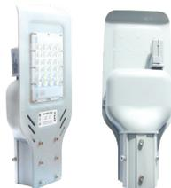
Фотодатчик в автоматическом режиме управляет светильником, включая его при наступлении темноты и выключая на рассвете. Это существенно сокращает расход электроэнергии уличных светильников, а также продлевает срок их службы.
